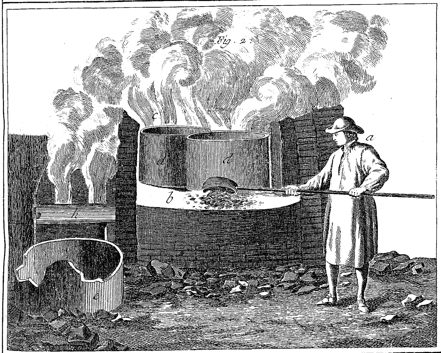
Verrerie en bois, l'opération de retirer le vieux pot cassé et nettoyage du banc.
