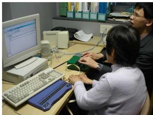
ブリスタは6つのキーの組み合わせで点字を入力する盲ろう者用の通信用点字速記タイプライタ。打った点字は左側から紙テープで打ち出され、盲ろう者はその点字を触って通訳を受けます。
